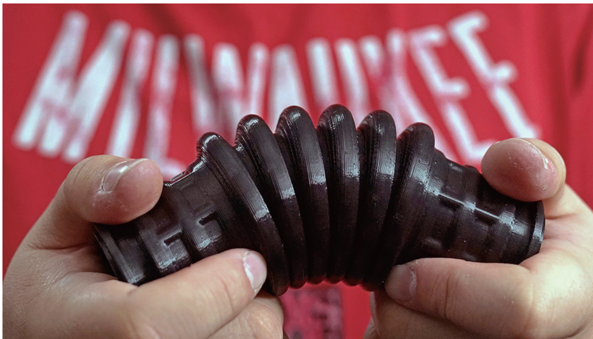
使用柔性 FDM TPU 92A 彈性材料列印的進氣軟管。
