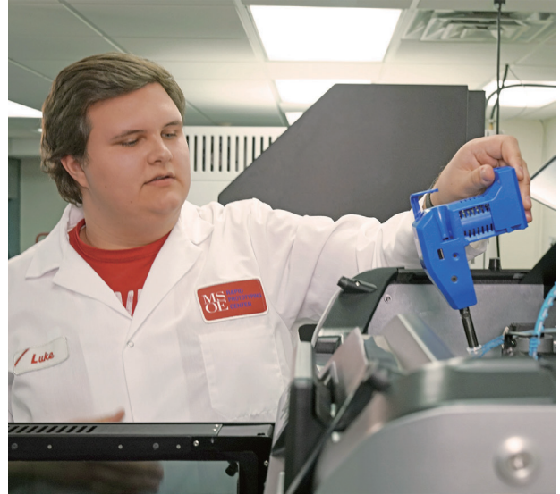
有了可互換的擠壓頭，可以輕鬆快速地轉換到彈性材料列印。
